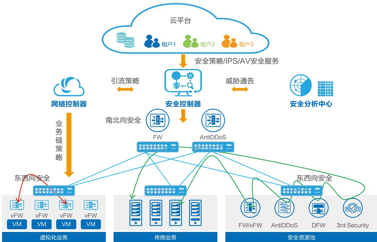
图 3 网络安全联动处置示意图
